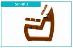
Die Verbindungseisen am Sitz und Rückenbrett werden passgenau in die Vertiefungen am Bankfuß eingelegt.
