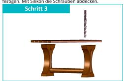
Mit Spiralbohrer (ø = 6mm) durch die Löcher der Verbindungseisen Vorbohrungen in den Tischfüßen vornehmen.(8x Tischelement)
