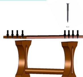
Befestigen Sie das Tischbrett mit den gelieferten Schrauben am Tischfuß. Legen Sie den O-Ring mit der glatten Seite Richtung Tischfuß unter die Schrauben. Die Kappen werden über die Schraubköpfe gestülpt und angeedrückt.
