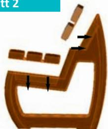
Die Verbindungseisen am Sitz und Rückenbrett werden passgenau in die Vertiefungen am Bankfuß eingelegt.
