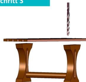
Mit Spiralbohrer ( $\varnothing = 6\text{mm}$ ) durch die Löcher der Verbindungseisen Vorbohrungen in den Tischfüßen vornehmen. (8x Tischelement)
