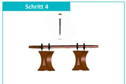
Befestigen Sie das Sitzbrett mit den gelieferten Schrauben am Bankfuß. Legen Sie den O-Ring mit der glatten Seite Richtung Bankfuß unter die Schrauben. Die Kappen werden über die Schraubköpfe gestülpt und angedrückt.
