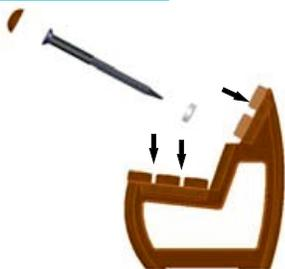
Befestigen Sie das Sitzbrett mit den gelieferten Schrauben am Bankfuß. Legen Sie den O-Ring mit der glatten Seite Richtung Bankfuß unter die Schrauben. Die Kappen werden über die Schraubköpfe gestülpt und angeedrückt.
