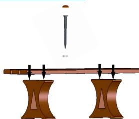
Befestigen Sie das Sitzbrett mit den gelieferten Schrauben am Bankfuß. Legen Sie den O-Ring mit der glatten Seite Richtung Bankfuß unter die Schrauben. Die Kappen werden über die Schraubköpfe gestülpt und angeedrückt.
