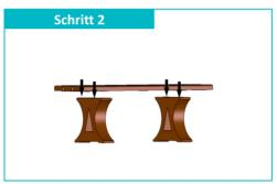
Die Verbindungseisen am Sitzbrett werden passgenau in die Vertiefungen am Bankfuß eingelegt.
