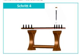
Befestigen Sie das Tischbrett mit den gelieferten Schrauben am Tischfuß. Legen Sie den O-Ring mit der glatten Seite Richtung Tischfuß unter die Schrauben. Die Kappen werden über die Schraubköpfe gestülpt und angedrückt.
