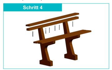
Montieren Sie als nächstes die Bankbohle auf dem Sitzbrett, bündig zur vorderen Kante, durch die vorgebohrten Löcher von unten (6 Schrauben 6 x 70 mm).
