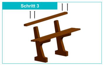
Richten Sie die Sitzauflage bündig zur hinteren Kante Bandfußes aus und verschrauben Sie diese mit den Schrauben 6 x 120 cm durch die Vorbohrungen (je Bankfuß 2 Schrauben).
