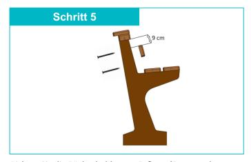
Richten Sie die Rückenbohlen am Fuß aus (9cm von der Unterkante der Sitzauflage) und verschrauben Sie die Bohlen durch die vorgebohrten Kanäle. Je Bankfuß 2 Schrauben (6x120 mm).
