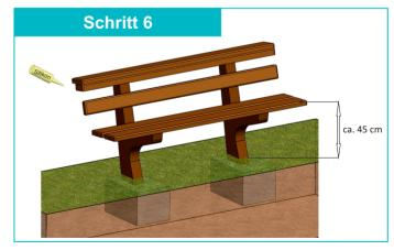
Bringen Sie die Bank in ein Betonfundament und fixieren Sie diese während der Trockenphase des Betons. Erst nach vollständiger Aushärtung kann die Bank belastet werden. Die Schraubenköpfe im Rückenbereich werden mit Silikon abgedeckt.
