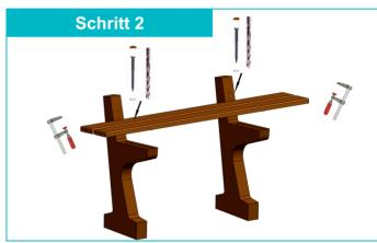
Setzen Sie das vormontierte Sitzelement auf die Füße auf. Die Verbinder in den Aussparungen ausrichten und mit den Schrauben (8 x 70 mm) fixieren.
