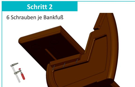
Das Sitzbrett gleichmäßig an den Bankfüßen ausrichten und mit Schraubzwingen fixieren (die Montage auf einer Werkbank kann den Aufbau erleichtern). Verschraubungen gemäß Bohrbild Seite 1, a-c, vornehmen. Vorbohren mit Bohrer 5mm, 11mm Bohrer zu versenken der Schraubköpfe.
