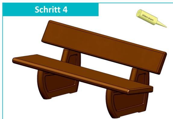
Decken Sie alle Schraubensenkungen mit Silikon ab und streichen Sie es anschließend glatt.
