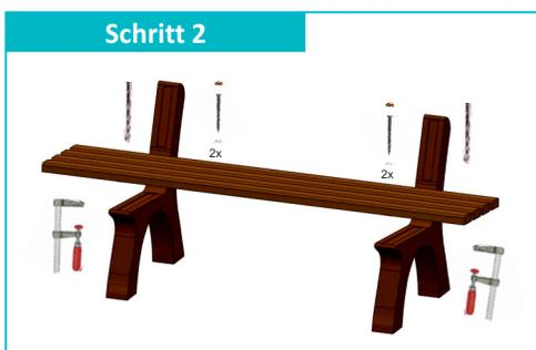
Setzen Sie das Sitzelement auf die Füße auf. Die Einleger in den Aussparungen ausrichten und mit den Schrauben befestigen. (Die Schrauben werden mit O-Ringen unterlegt)
