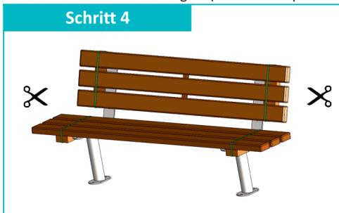
Nach der Montage kann die Montagehilfe entfernt werden. Schneiden Sie hierzu das grüne Band vorsichtig durch (Band steht unter Spannung). Achten Sie auf einen sicheren und stabilen Stand der Bank.
