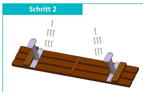
Richten Sie den Bankfuß an der Montagehilfe mittig aus und bohren Sie mit einem 6mm Spiralbohrer durch die vorgegebenen Löcher in Bankfuß vor. Verschrauben Sie den Fuß (7 Schrauben pro Fuß) mit dem Sitzelement.
