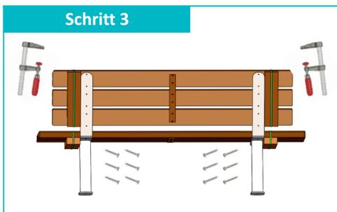
Stellen Sie die Bank mit den Füßen auf den Boden (Vorsicht kipppfahl) und montieren Sie das Rückenelement entsprechend Schritt 2. Sichern Sie zur Montage das Element mit Schraubzwingen. (6 Schrauben pro Fuß)
