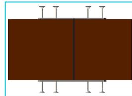
Die Unterkonstruktion darf maximal 6,0 x 6,0 m als Einheit verbaut werden. Bei größeren Flächen sind neue Module aufzubauen, die durch eine Dehnfuge getrennt werden.
