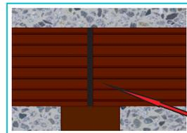
Der seitliche Überstand der Terrassendielen über die Unterkonstruktion darf maximal 20 mm betragen.
