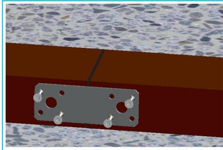
Verschrauben Sie die Unterkonstruktion an den Stoßkanten doppelt mit den Verbindungsblechen. Die Unterkonstruktion wird nicht mit dem Fundament verschraubt.
