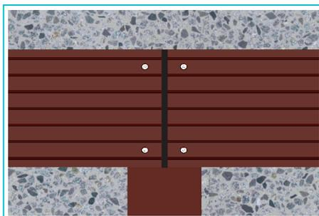
Anschließend werden die Dielen mit der Unterkonstruktion verschraubt. Verwenden Sie hierfür handelsübliche Terrassenbauschrauben (z.B. Torx, V2A, 4,5 x 60 mm). Wir empfehlen die Dielen vorzubohren und die Bohrlöcher entsprechend dem Kopfdurchmesser zu senken.
