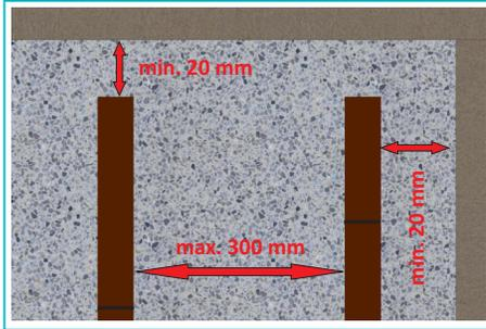
Legen Sie die Unterkonstruktion mit einer lichten Weite von max. 300 mm flach (nicht hochkant) aus.
