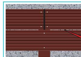
Pro Unterzug wird jede Diele doppelt verschraubt.
