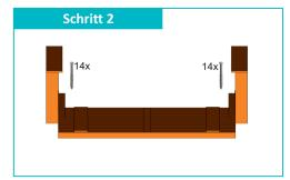
Richten Sie die Tischfüße am Tischelement aus und verschrauben Sie die Füße mit je 14 Schrauben pro Seite (Schrauben 6x40mm). Wir empfehlen vorzubohren.
