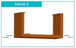
Verschrauben Sie die Tischfüße zusätzlich mit je 2 Schrauben (6x140mm) von außen durch die vorgebohrten Löcher mit dem Tischelement.
