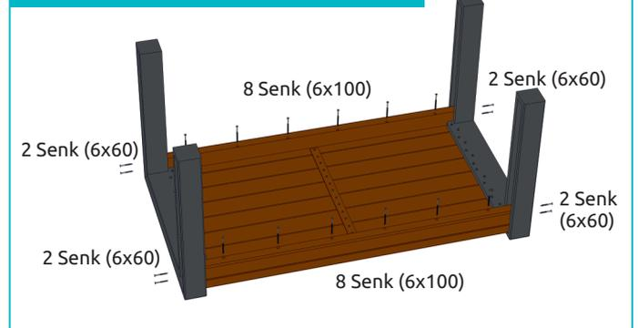
Bankbohle bis an das Tischelement schieben. Schrauben in die vorgebohrten Löcher einschrauben. Je Seitenlänge von unten 8 Senkkopf (6x100cm) und je Ecke von außen 2 Senkkopf (6x60cm).
