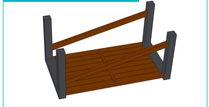
Bankbohle mit vorgebohrten Löchern quer einsetzen. Bohrbild muss nach innen zeigen
