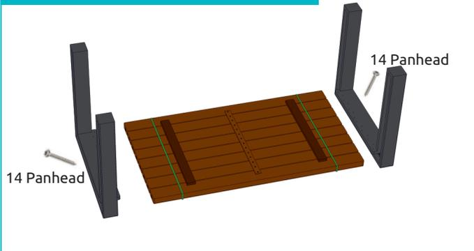
Tischelement auf eine saubere Unterlage legen. Tischfüße mit der Aussparung über das Tischelement schieben und mit dem Schonhammer vorsichtig einschlagen. Schrauben in die vorgebohrten Löcher eindrehen (je Seite 14 Pan-Head 6x60cm).
