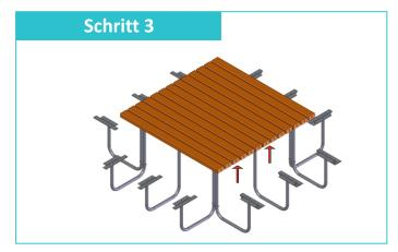
Legen Sie nun die Bankbohlen der Tischfläche in einem Abstand von ca. 16,5mm zueinander auf und richten diese mittig zum Bankfuß aus. Verschrauben Sie anschließend jede Bohle von unten mit je 4 Spanplattenschrauben Ø6x40mm Pan-Head.
