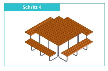
Legen Sie nun Die Bankbohlen der Sitzflächen auf dem Bankfuß auf und richten diese mittig zur Auflage und zur Tischfläche aus. Der Bohlenabstand beträgt hier ca. 25mm. Verschrauben Sie Anschließend jede Bohle von unten mit je 6 Spanplattenschrauben Ø6x40mm Pan-Head.
