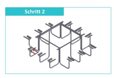
Verschrauben Sie die mitgelieferten Winkelprofile für die Sitzbelegung mit dem Bankfuß. Verwenden Sie hier bitte auch die "Sechskantschraube DIN EN 933 - M8 x 30" mit passenden U-Scheiben und Muttern.
