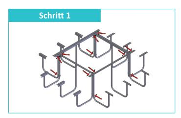
Stellen Sie die Elemente der Bankfüße auf einer ebenen Fläche auf und verschrauben diese im oberen Bereich mit 8 Stück "Sechskantschraube DIN EN 933 - M8 x 30" und passenden U-Scheiben und Muttern durch die vorgebohrten Löcher. Verschrauben Sie die Bankfüße anschließend im unteren Bereich durch die vorgebohrten Löcher mit 4 Stück "Flachrundschraube DIN 603 M8x90" und passenden U-Scheiben und Muttern.
