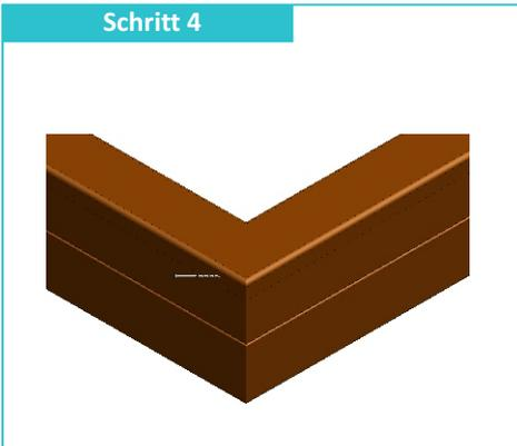
Verschrauben Sie die Ecken der Sitzauflage mit jeweils einer Schraube (6 x 80mm).
