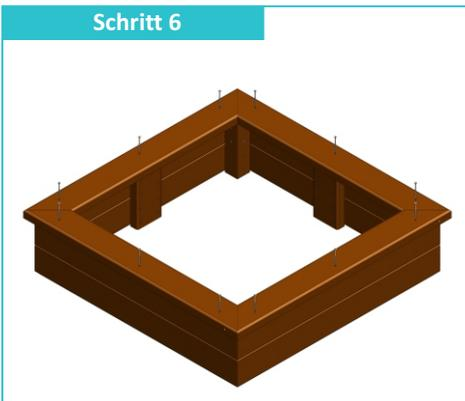
Verschrauben Sie die Sitzauflagen mit den Seitenteilen von oben mit je 3 (bzw 5) Schrauben (6 x 80 cm) pro Seite. Anschließend kann der Sandkasten mit Sand befüllt werden und ist spielbereit.
