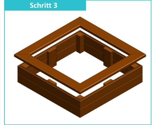
Legen Sie alle Sitzauflagen auf die Seitenteile auf. Achten Sie bei der Montage der Sitzauflagen darauf, dass die abgerundeten Kanten nach oben zeigen.
