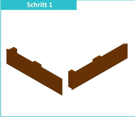
Legen Sie zwei Sandkastenprofile auf einer ebenen Fläche aus.
