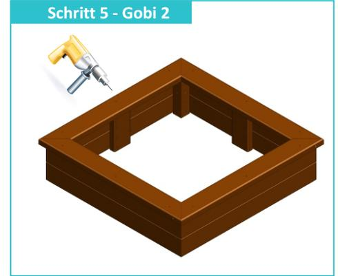
Richten Sie die Sitzauflage mittig zur Unterkonstruktion aus und bohren diese nun mit jeweils 5 Löchern vor. Setzen Sie die erste Bohrung mittig an und anschließend in beide Richtungen je 2 Bohrungen im Abstand von je 55 cm.
