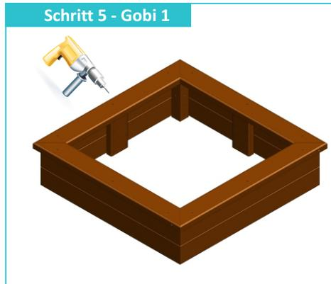
Richten Sie die Sitzauflage mittig zur Unterkonstruktion aus und bohren diese nun mit jeweils 3 Löchern vor. Setzen Sie die erste Bohrung mittig an und anschließend in beide Richtungen je 2 Bohrungen im Abstand von je 45 cm.
