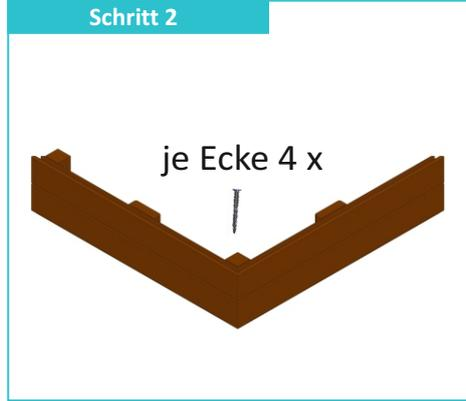
Setzen Sie die Teile so zusammen, dass die Profile passgenau aneinander liegen und verschrauben (6 x 100 mm) diese von innen. Wiederholen Sie diesen Schritt mit den weiteren Seitenteilen.
