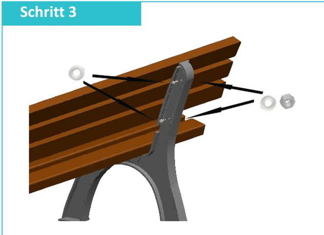
Richten Sie das vormontierte Rückenelement an den Vorbohrungen des Bankfußes aus und verschrauben Sie es pro Bankfuß mit je 2 Schrauben (8x30mm), 2 Muttern und 4 Unterlegscheiben.
