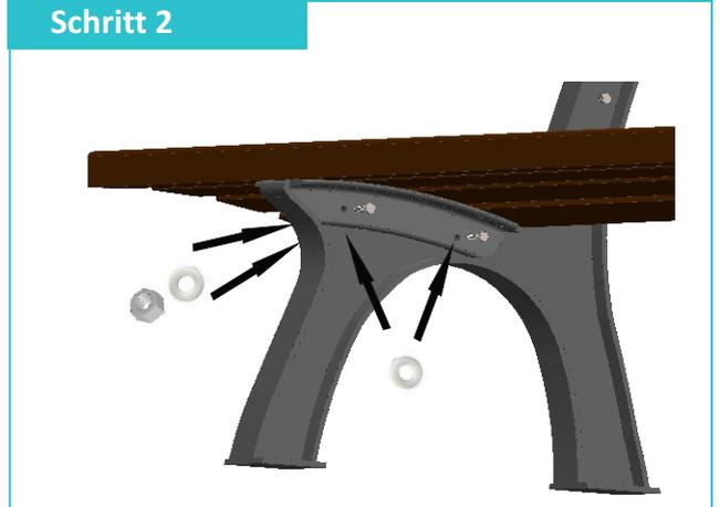
Richten Sie das vormontierte Sitzelement in den Vorbohrungen des Bankfußes aus und verschrauben Sie es mit je 2 Schrauben (8x30mm), 2 Muttern und 4 Unterlegscheiben pro Bankfuß.
