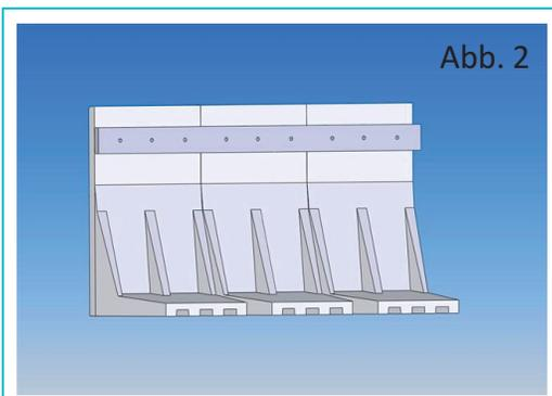
Die L-Steine werden mittig auf ein 60 cm breites und 20 cm tiefes, frostfrei gegründetes Betonfundament gesetzt.
